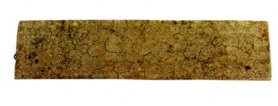
Bild A3: Oberfläche des CEM I 42,5 R + \text{CaSO}_4 nach 90d WL in 8facher Vergrößerung
