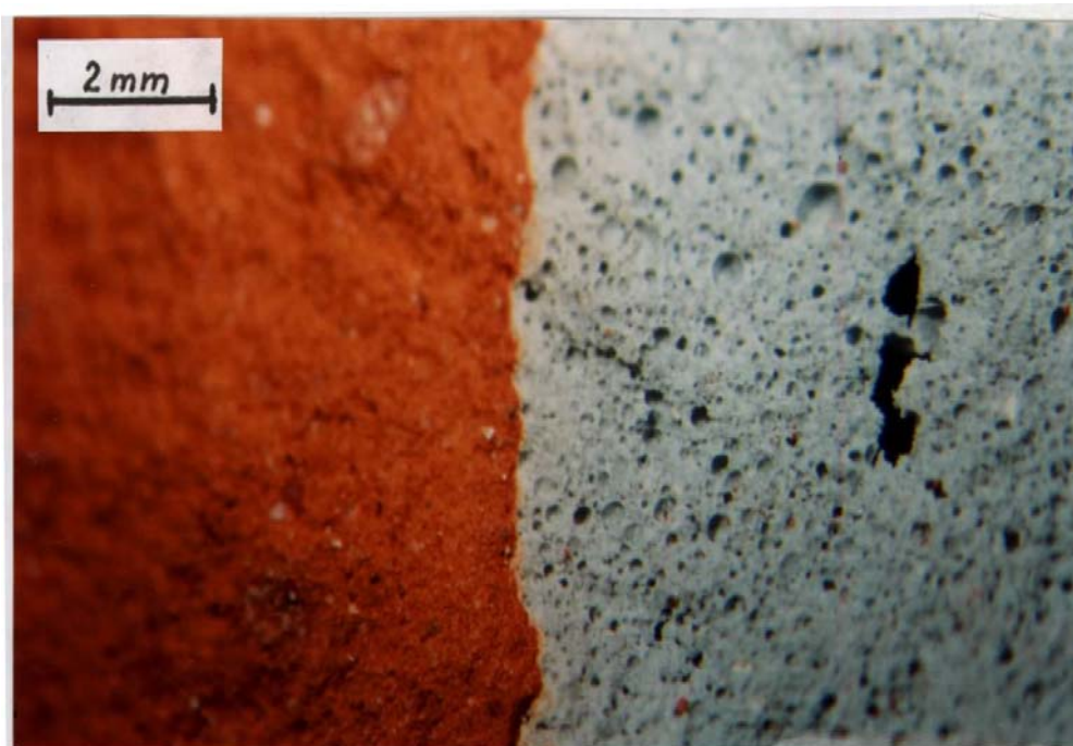
Bild 99: Kontaktfläche zwischen dem VMz 28-1,8-NF und HAZ-ISM
