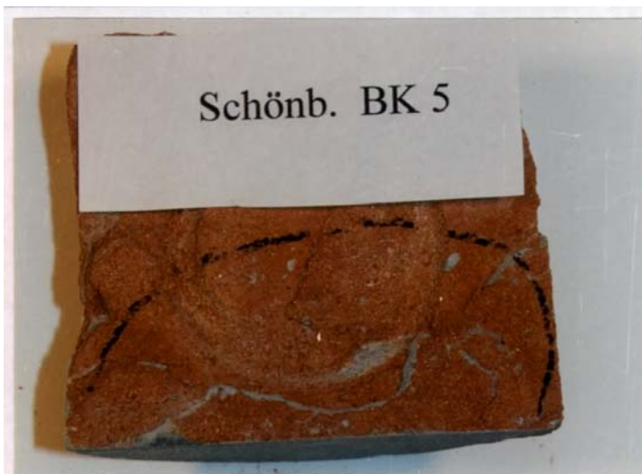
Bild 136: Schaummörtel in Rissen des Sandsteines in 8facher Vergrößerung
