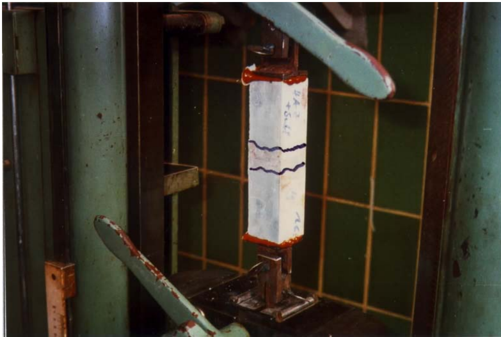
Bild 91: Verbundprisma mit eingebettetem Naturstein während der Prüfung
