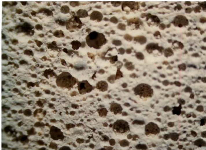
Bild 43: Schaummörtelgefüge mit unvollständig getränkten Poren in 30facher Vergrößerung
