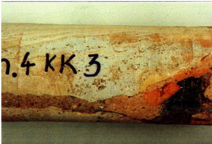
Bild 12: Thuramentinjektion im Kontakt zum Fugenmörtel aus hydraulischem Kalk (Maßstabsbalken = 2,5 mm)
