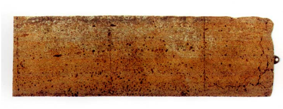
Bild A2: CEM I 42,5 R-Schaummörtel + \text{MgSO}_4 nach 1 1/2a Feuchtlagerung
