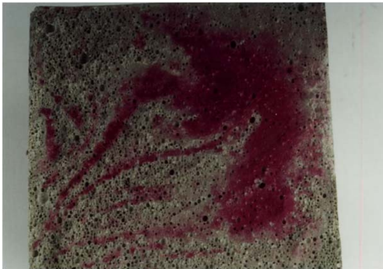
Bild 88: Carbonatisierungstiefe der Prüfkörper aus HAZ und CEM I 42,5 R-HS nach 14tägiger Carbonatisierung (1Vol% CO 2 )
