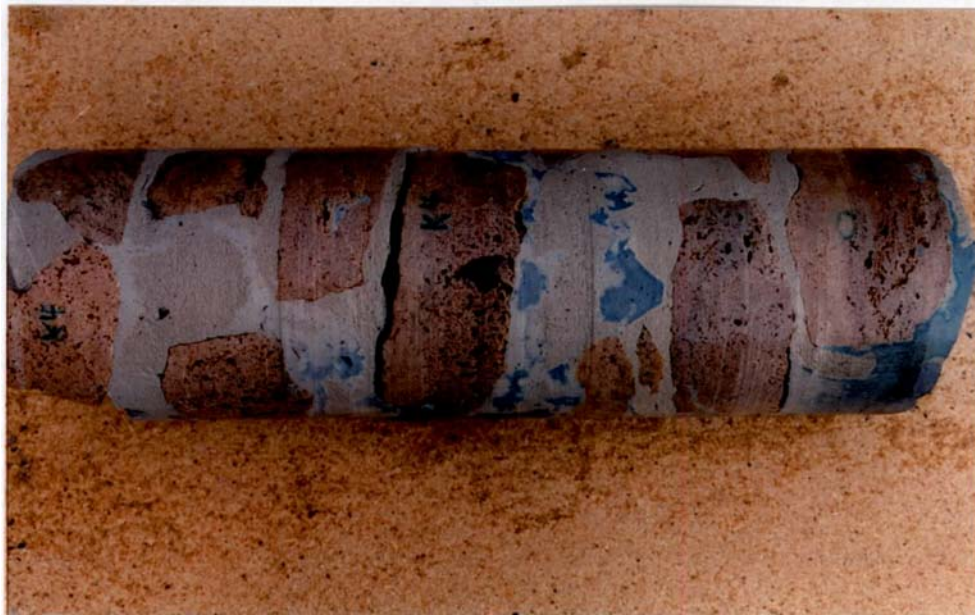
Bild 101: Kontaktflche zwischen Travertin und ISM (CEM I 42,5 R-HS) (Mastabsbalken = 2 mm)
