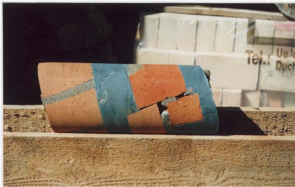
Bild 98: Bohrkern aus der Ziegelmodellmauer
