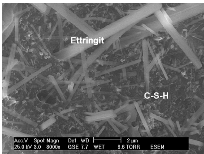
Bild 48: Matrix des CEM I 42,5 R-HS Schaummörtels in 8000facher Vergrößerung (WET)
