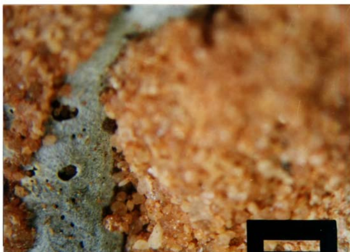
Bild 136: Schaummörtel in Rissen des Sandsteines in 8facher Vergrößerung
