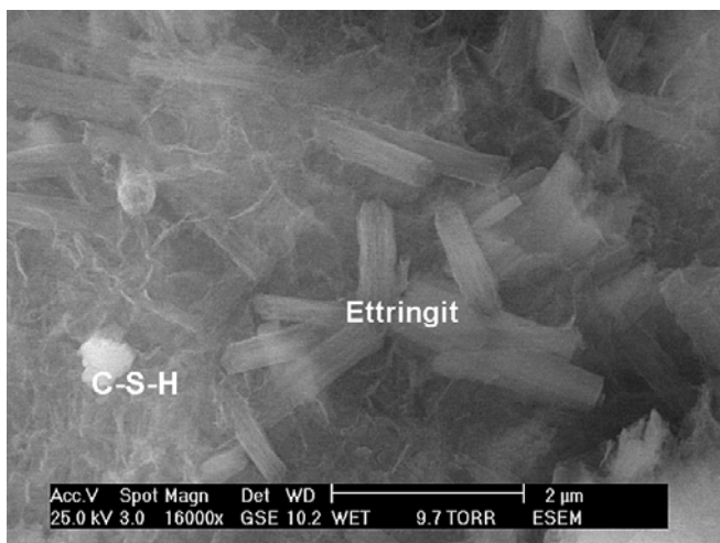
Bild 53: HAZ-Gefüge (mit Schaum) mit Faserbündeln aus CSH-Phasen und Ettringit in 16000facher Vergrößerung (WET)
