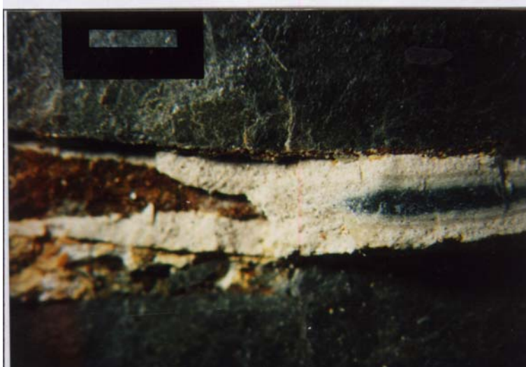
Bild 9: Zementleiminjektion in einer Mikrokluft; Zementstein überwiegend karbonatisiert (Maßstabsbalken = 2,5 mm)
