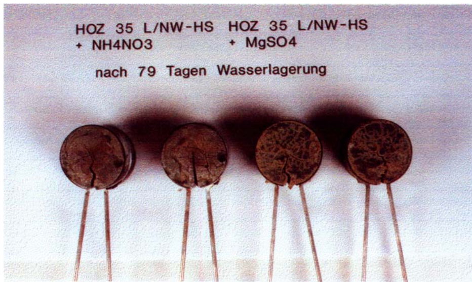
Bild A7: CEM III/B 32,5-NW/HS+ MgSO 4 und +NH 4 NO 3 (Le-Chatelier-Ringe)
