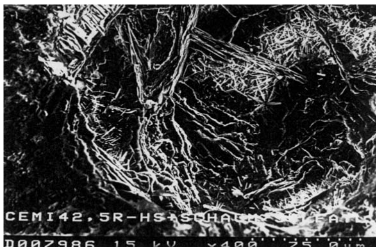
Bild A12: Pore im CEM I 42,5 R-HS-SM nach 56 d Sulfatlagerung; REM-Aufnahme in 600facher Vergrößerung
