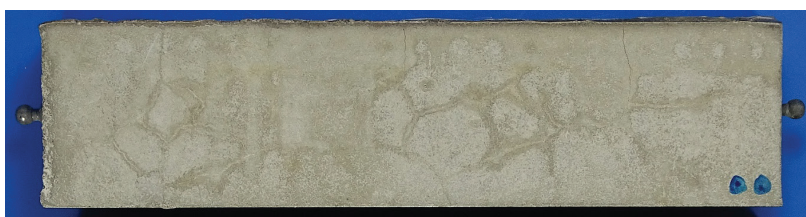
Abb. 5: Probekörper mit oberflächlichen Rissen nach Klimawechsellagerung
