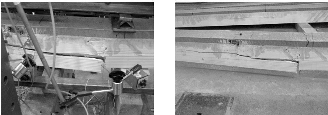
Abb. 5-22 Schubversagen im Lasteinleitungsbereich (PK B/14/3-6)
