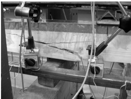
Abb. 5-19 Typische Ausbildung von Biegezugbrüchen (links: B/10/3-2, rechts: B/14/2-4)
