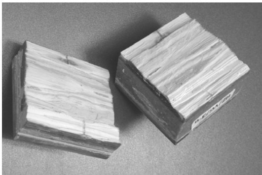
Abb. 5-3 Kohäsionsbruch zu 100% im Holz
