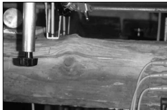
Abb. 4-11 Faltenbildung im Druckbereich
