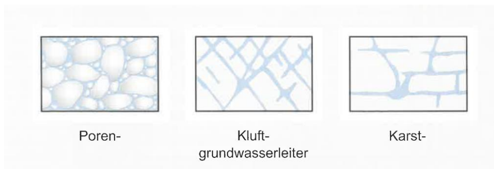
Abb. 2-2: Arten der Grundwasserleiter (Quelle: Hölting und Coldewey, 2013)
