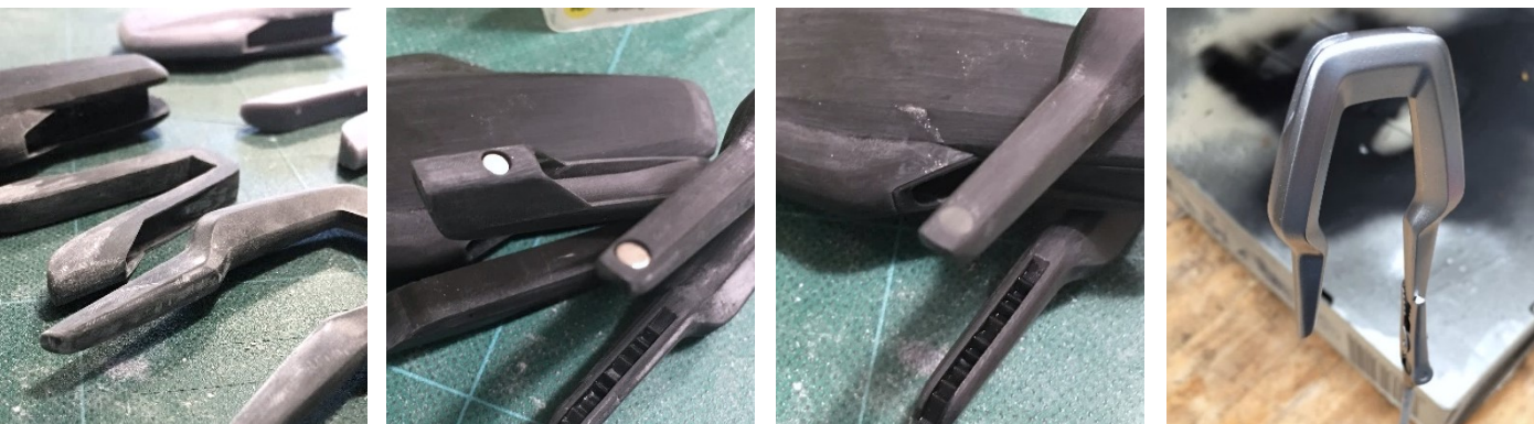
Abb. 310 - Fotos: Modellbauarbeiten, schleifen, polieren, Einsatz v. Magneten, Lackierarbeiten; J. Velte
