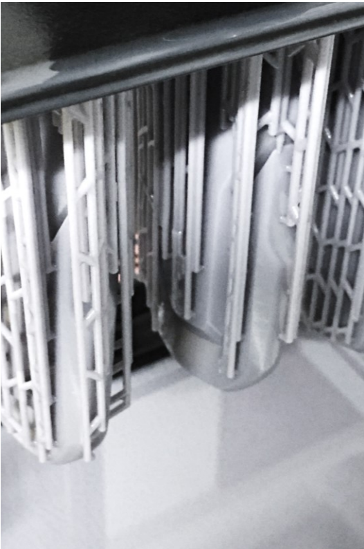
Abb. 286 - Foto: erste Mock-Up- Proportionsmodelle; SLA-Druck; J. Velte
