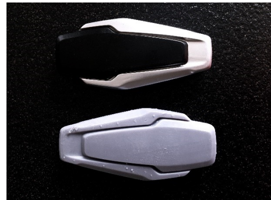
Abb. 294 - Bild/Fotos: Druckvorbereitung; 3D-Druck mit Struktur; Mock-Up-Modelle im Größen-Vergleich; J. Velte
