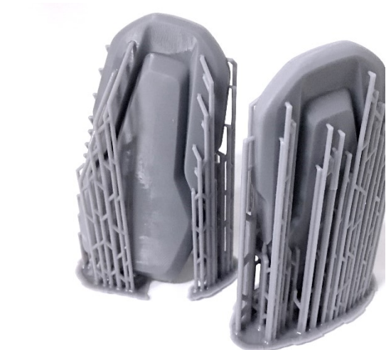
Abb. 296 - Foto: SLA-Modelle; verschiedene Größen, in Stützstruktur; J. Velte
