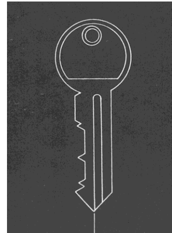
Abb. 4 - Yale-Schlüssel - Prinzipdarstellung; Abbildung - Gabriel Mandel
