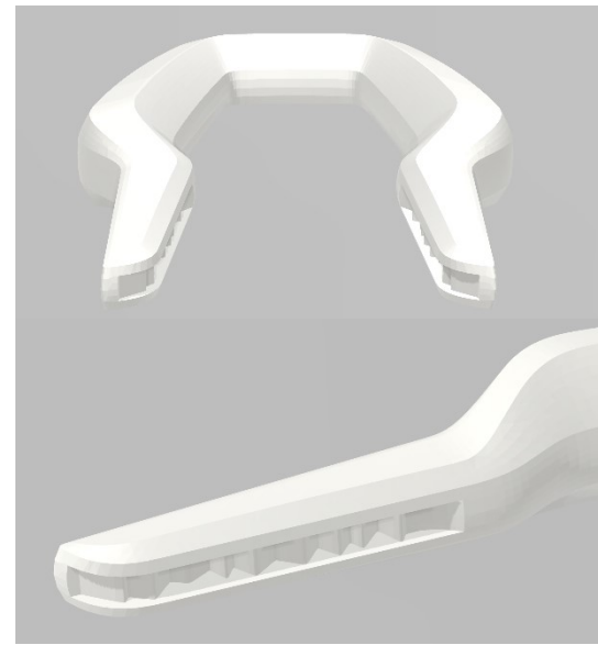
Abb. 313 - Bilder: CAD-Daten „verdeckte Zahnung“; J. Velte
