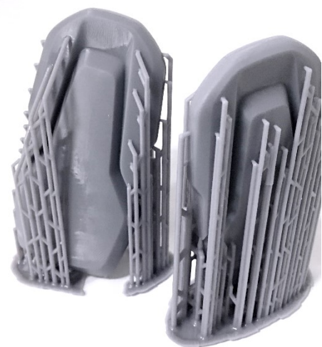
Abb. 296 - Foto: SLA-Modelle; verschiedene Größen, in Stützstruktur; J. Velte
