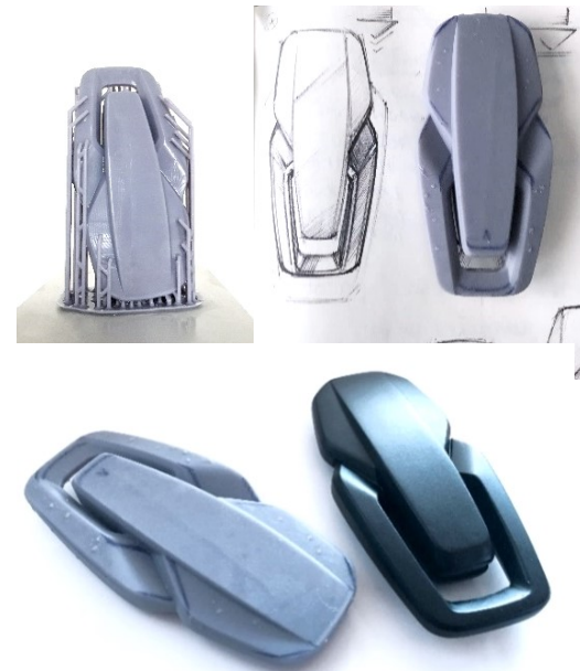
Abb. 301 - Foto: Erstes 3D-Mock-Up-Modell BETA V3; Check-Up im Skizzenbuch; Vergleich der Proportionsmodelle; J. Velte
