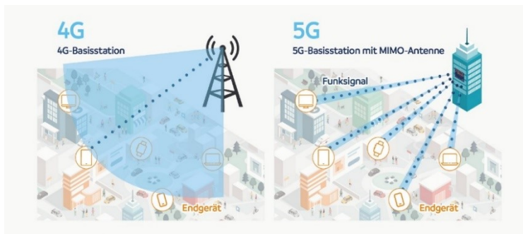
Abb. 10 - Schema: 5G-MIMO-Architektur; Quelle: Informationszentrum Mobilfunk
