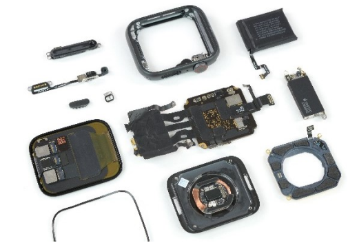
Abb. 306 - Foto: Smart Watch Bauteile; ifixit.com
