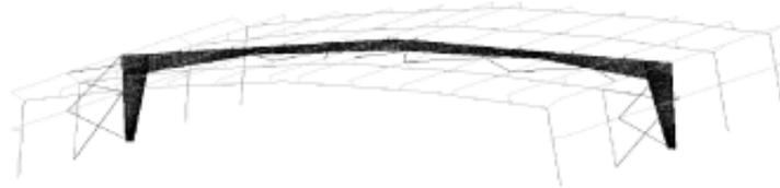
Abb. 4 Statisches Modell eines Hallenrahmens
