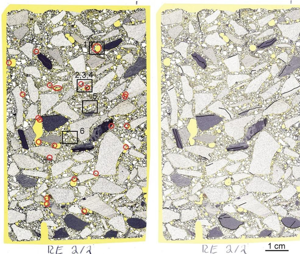
Abbildung 7.16.: Dünnschliffaufnahme des beschallten Betons (rGK-PUS) unter Lichtmikroskop. Links mit roten Kreisen gekennzeichnetes AKR-Gel und schwarze Ziffern für Detailbilder und rechts mit Kennzeichnung der Risse
