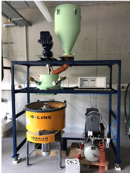
Abbildung 7.34.: Anlagenkonzept 3 mit Zementdosierung, Rührwerkzeug, Ultraschallgeneratoren und Schwingelementen sowie Behälter und Betonmischer.
