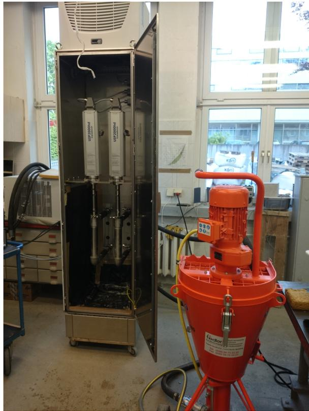
Abbildung 7.2.: Anlagenkonzept 1; Ultraschall-Suspensionsmischsystem
