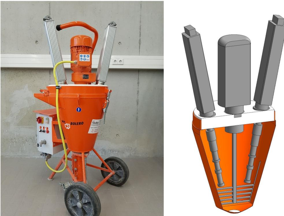
Abbildung 7.24.: Ultraschallmischer der Stufe 2
