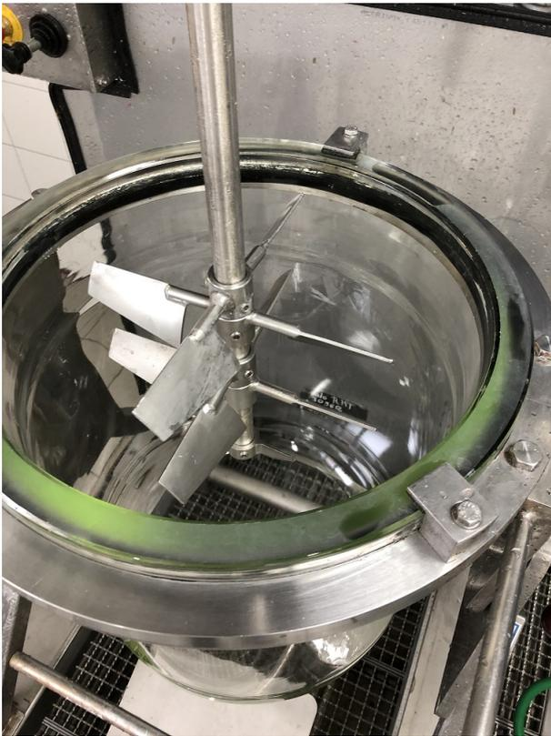
Abbildung 7.30.: Test verschiedener Rührorgane in einem Testbehälter aus Glas.
