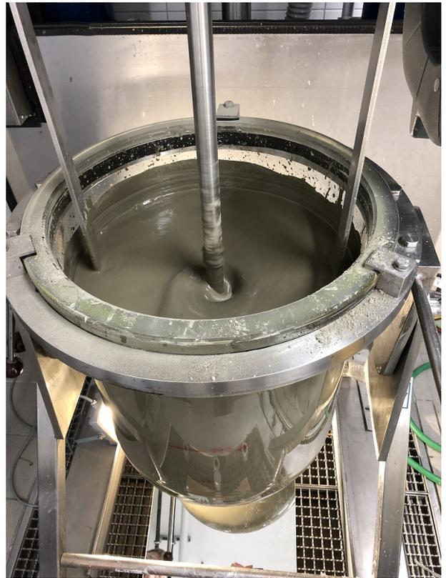
Abbildung 7.31.: Test der Rührwerkzeugkonfiguration mit Zementsuspension bei einem w/z-Wert von 0,50.
