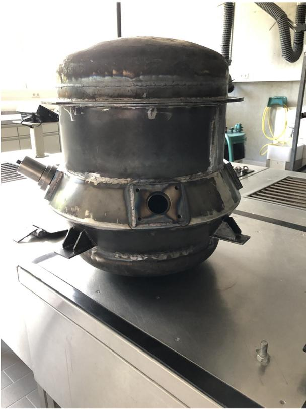
Abbildung 7.32.: Fertiger 30-Liter Stahlbehälter mit einer Aufweitung für den Einbau der Schwingelemente.
