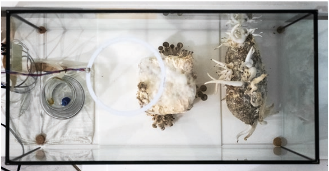
die Fruchtkammer, mit einer Aquarienpumpe ausgestattet
