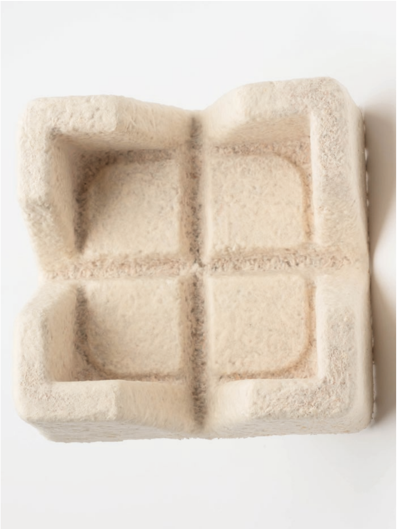
10. ein Blumentopf aus Myzel in Closeup. Myzel lässt sich Spritzgussähnlich formen.
