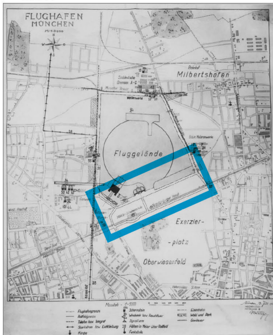
Stadtarchiv München, 1927-1930, Entwurf K. I. Moßner. Flughafen Oberwiesenfeld. Lageplan des Fluggeländes, mit Milbertshofen und Exerzierplatz Oberwiesenfeld, mit Details wie Signal-türmen, Starkstrom- und Telefonleitungen und Rollfeldgrenzen, Maßstab 1:5000. [DE-1992-FS-HB-V-d-2701 Flughafen Oberwiesenfeld, 27.07.1927 (Einzeldokument).] Scale 1:5000. < https://stadtarchiv.muenchen.de/scopeQuery/detail.aspx?ID=473309 > (accessed May 18, 2017).
