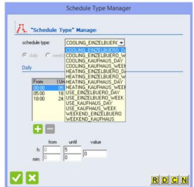
Bild 6. Übersicht der im BIM-Modell hinterlegten Schedule-Types, die in TRNBuild zur Auswahl stehen Fig. 6. Overview of the available Schedule-Types in TRNBuild, which were integrated into the BIM-model
