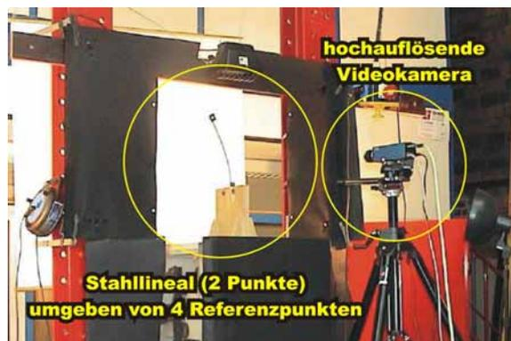
Abbildung 16: Messaufbau mit Videokamera
