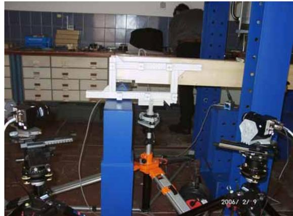
**Abbildung 10:** Versuchsaufbau (Stereomodell) mit Holzprobe und Referenzrahmen
