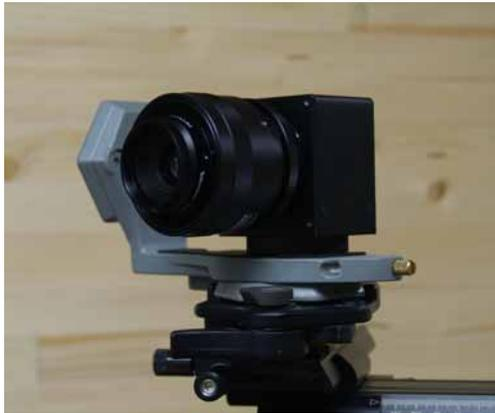
**Abbildung 7:** hochauflösende Videokamera SVS11000 (11 Megapixel), Eigentum der Prof. Holz- und Mauerwerksbau
