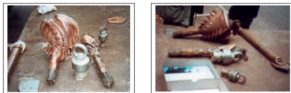
Abb. 4.96: Werkzeuge (Bohrkopf, Kupplungen zum Ankoppeln des ersten Rohres)
