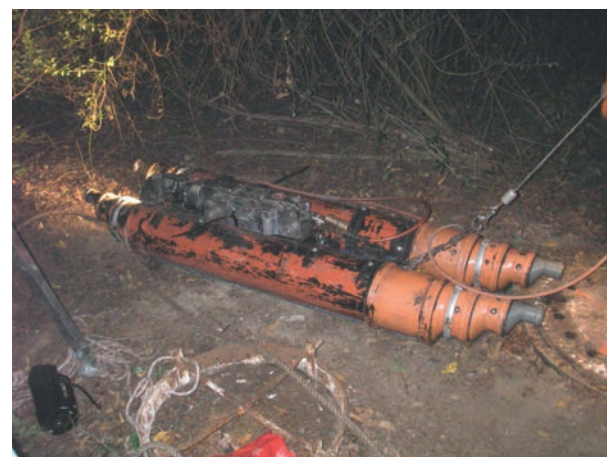
Abb. 7.5: Schwimmfähiger TV-Inspektionsroboter Argus 4 [Bosseler und Sokoll, 2007] (Hersteller: IBAK Helmut Hunger GmbH u. Co. KG) mit Schwimmfloß (Hersteller: Lönne Entsorgung GmbH u. Co. KG)
