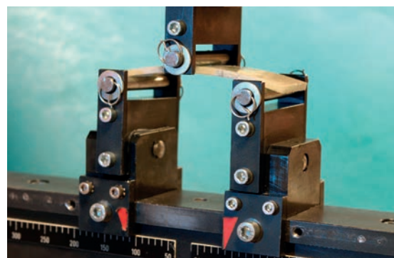
Abb. 7.45: Linerprobe im Drei-Punkt-Biegeversuch
