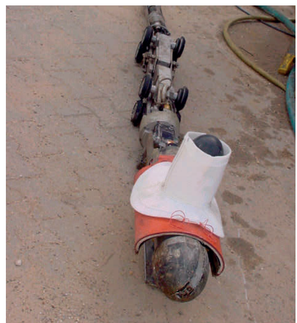
Abb. 7.22: Packer mit Hutprofil (aus [Bosseler und Kaltenhäuser, 2004])
