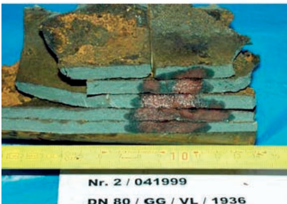
Abb. 4.26: Graphitierung; Bruchstücke mit Graphitierung
