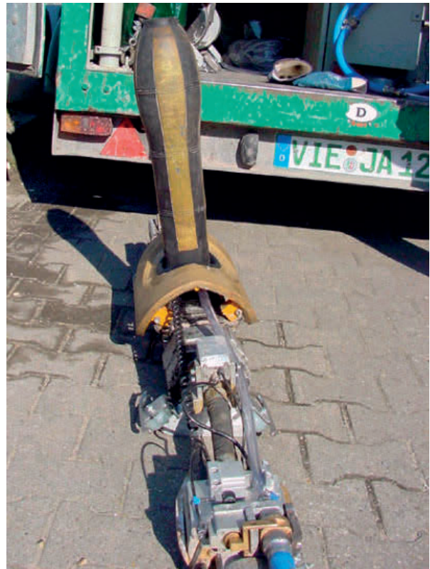
Abb. 7.21: Injektionspacker mit Schalungsschild und Absperrblase (aus [Bosseler und Kaltenhäuser, 2004])
