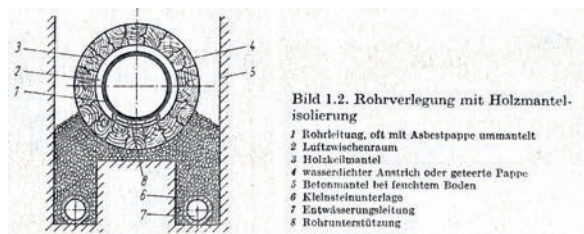
Abb. 8.10: Rohrverlegung mit Holzmantelisolierung [Munser und Steinbach, 1994]
