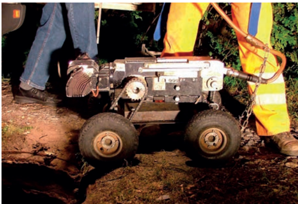
Abb. 7.6: Unbemannter fahrender TV-Inspektionsroboter Argus 4 [Bosseler und Sokoll, 2007] (Hersteller: IBAK Helmut Hunger GmbH u. Co. KG) mit Fahrgestell (Hersteller: Pader Kanal Technik – Rohr Frei GmbH u. Co. KG)
