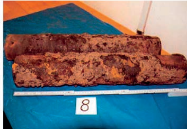
Abb. 3.15: Jutearmiertes Rohr aus den 30er Jahren (Verrottung der Jutearmierung, nach Bearbeitung der Rohrprobe zeigt sich ausreichende Restwandstärke für Zementmörtelauskleidung)
