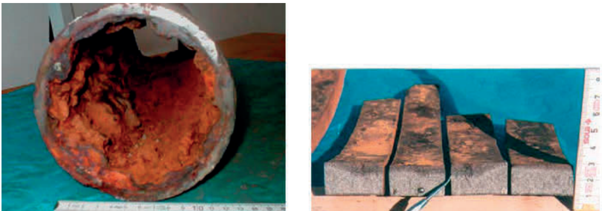
Abb. 3.13: Gussrohr mit Graphitierungserscheinungen, Bruchstücke mit Graphitierung [Roscher et al., 2000]
