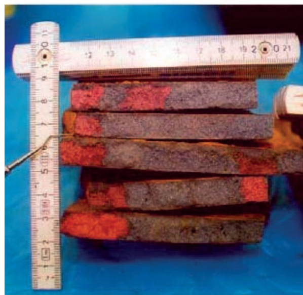
Abb. 4.20: Zustandsbewertung hinsichtlich der Graphitierung an einer Gussrohrprobe
