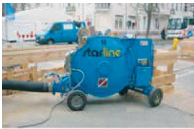
Mobile Drucktrommel für den Trinkwasser-einsatz
