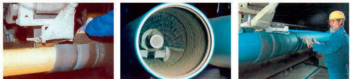
Abb. 3.20: Korrosionsschutz von Stahlrohren – Zementmörtelausschleuderung im Spritzverfahren und Zementmörtelumhüllung im Wickelverfahren von Stahlrohren
