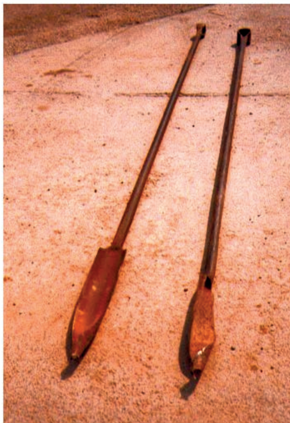
Abb. 3.8: Bohrwerkzeuge für das Röhrenbohren [Roscher, 1999]
