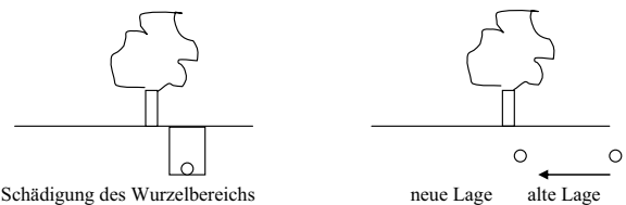
Abb. 4.90: Prinzip steuerbarer, grabenloser Vortrieb
