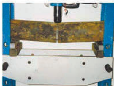
Rohrbruchsimulation im Rahmen der Quali-tätssicherung
