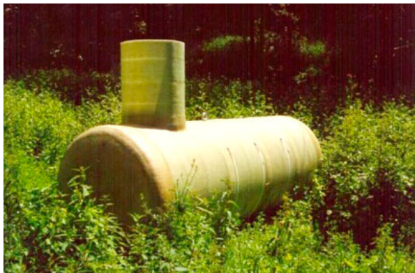
Abb. 7.18: Urinspeicher in der Lamberts-mühle (vor dem Einbau)
