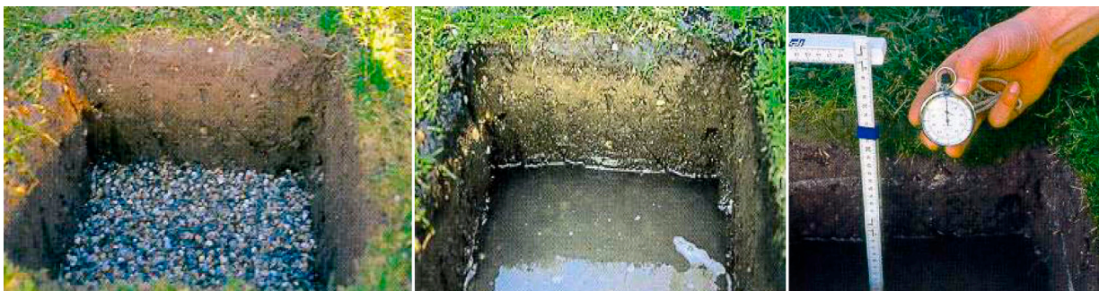
Abb. 3.6: Feldversuch zur Abschätzung der Versickerungsrate
