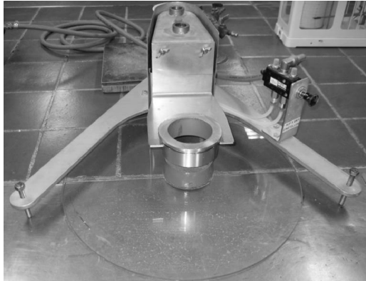
Abb. 3.1: Gerät zur Bestimmung des Fließmaßes
