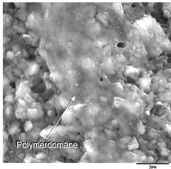
Abb. 4.99: Polymerdomäne im Gefüge von PSSC 3/15
