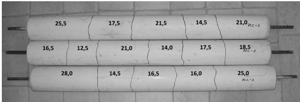
Abb. 4.107: Rissbild PCC (exemplarisch am Beispiel von PCC 1/10 p)
