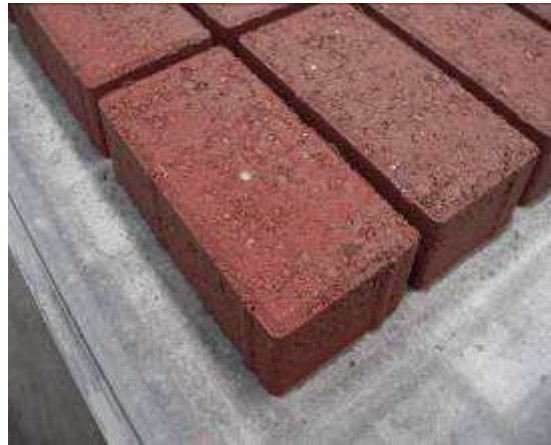
Abbildung 4.2: Proben aus Kernbeton
