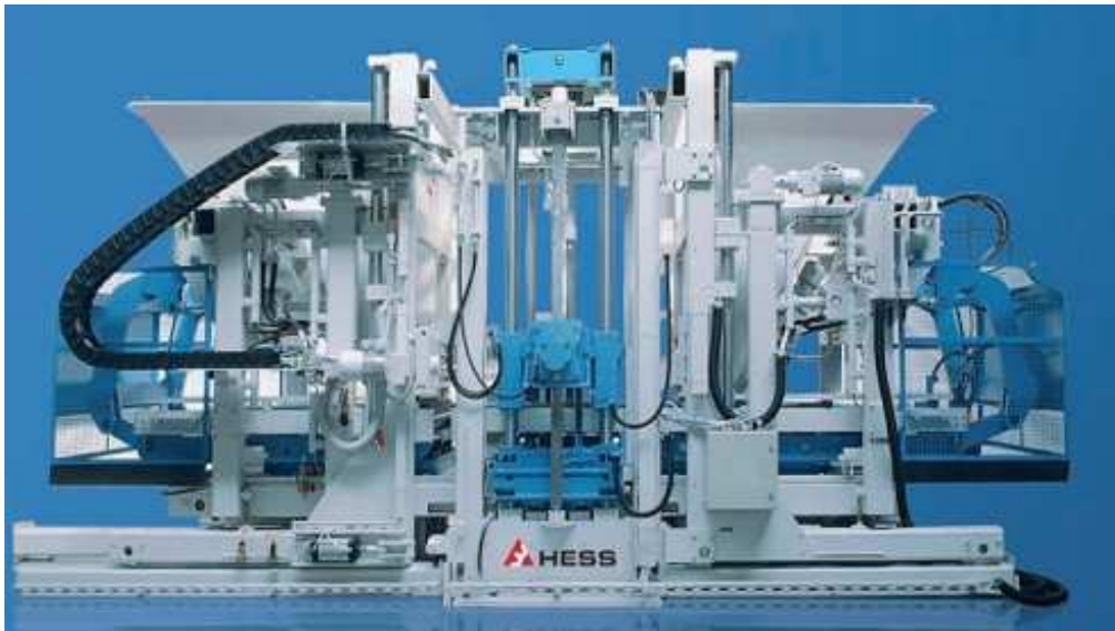
Abbildung 1.2: Moderne Steinformmaschine (Quelle: www.hessgroup.com )
