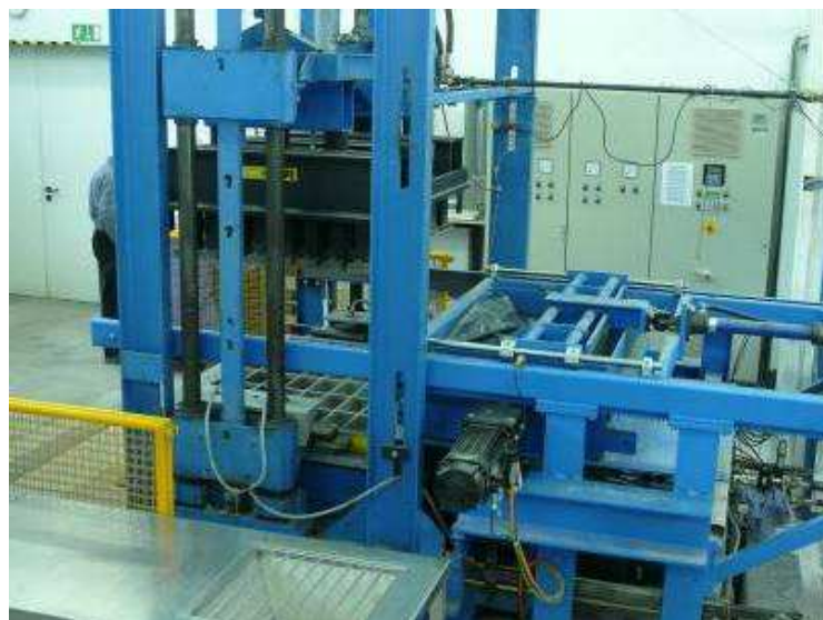
Abbildung 8.1: Versuchstand "Betonsteinfertiger" im Technikum des IFF Weimar e.V
