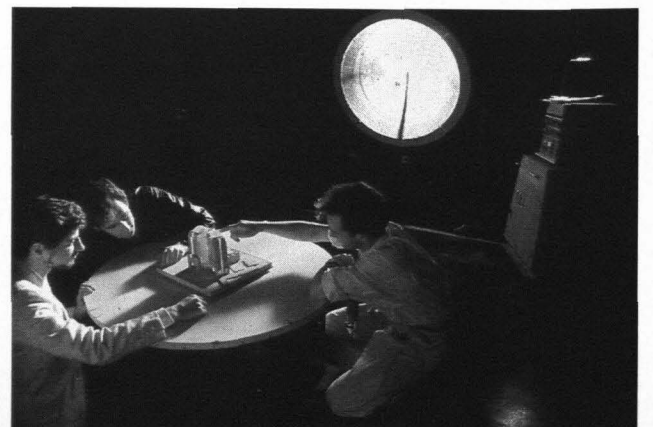
6 Zur Gestaltung von Licht als Faktor des Raums wird bei vielen Gebäuden die Wirkung von Kunst- und Tageslicht anhand von Modellen simuliert.
